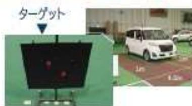
エーミング作業は、ターゲットを正確に置くために水平かつ指定された床の広さを確保します。
